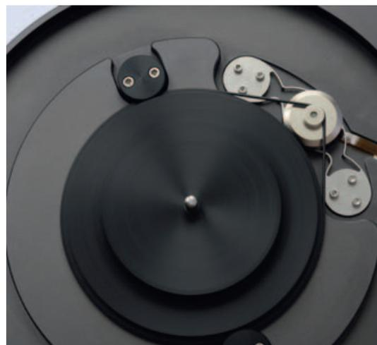
Zugunsten einer harten und engen Ankopplung des Drehmomentes an den Subteller sollte der Motor horizontal unbeweglich, aber trotzdem dem Chassis gegenüber bedämpft gelagert sein. Diese Forderungen erfüllt eine clevere Federhalterung. Die mechanische Ausführung ist, wie praktisch alles am Thales-Laufwerk, von feiner Qualität. Da der Subteller und damit das eigentliche Lager vormontiert ist, sorgen zwei runde Transportsicherungen für Halt.
